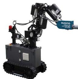
ハンドガンによるウォータージェット作業は全身に防護服を着用の上、超高圧水の噴射反力に長時間耐える必要があり、作業者の大きな負担になっていた。この半自動運転の小型ロボットは小回りの利くコンパクト設計で（装置幅 500 ミリ）、作業足場分の幅を通行できる。「無線遠隔操作、300N の許容噴射反力、半自動運転機能により安全かつ高効率なウォータージェット作業に貢献する」と言う。販売価格は税別 2000 万円からで、初年度販売 10 台を目指す。
