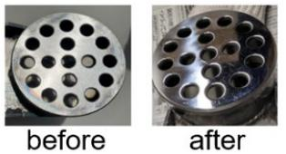
部品の一面への硬質クロムメッキ加工の依頼があり、現物を確認したところ、多数の穴と溶接された部品、可動部の真鍮ワッシャーという複雑な構造でした。真鍮はメッキ処理で溶解するため、丁番の溶接部を含め、メッキ不要箇所を厳重にマスキングで保護する必要がありました。
