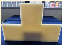
フローリングメーカー様より、製品の組み付け精度向上を目的とした検査治具のご依頼をいただきました。加工済みフローリング材のサイド溝に段差が生じないよう、迅速に精度確認ができる治具が必要とのお話でした。多様な角度を持つ多角形の溝に対応するため、3Dモデリングから着手し、4種類の治具を製作。軽量化のためABS樹脂を採用し、ご要望に応じた刻印も施しました。
